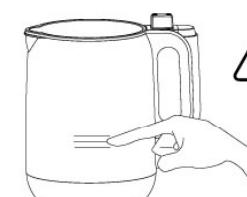
1. 机头、耦合器、底座、电源插座请勿进水，如果进水，必须擦拭晾干后才能使用。
