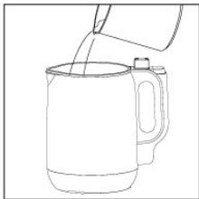
使用随机所配的干豆量杯，按食谱要求加入清水。（本机具有无水防干烧功能，如杯体内无水或水位过低，机器不会工作，以保证使用安全。）
