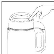
请将机头按正确的位置放入杯体中，插上电源线，指示灯全亮，按“选择”键选择相应功能程序，对应功能图形指示灯亮并闪烁，按“启动/取消”键启动相应制作程序。
