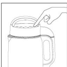
请将机头按正确的位置放入杯体中，插上电源线，指示灯全亮，按“选择”键选择奶茶，这时奶茶功能对应图形指示灯亮并闪烁，按“启动/取消”键启动奶茶制作程序。
